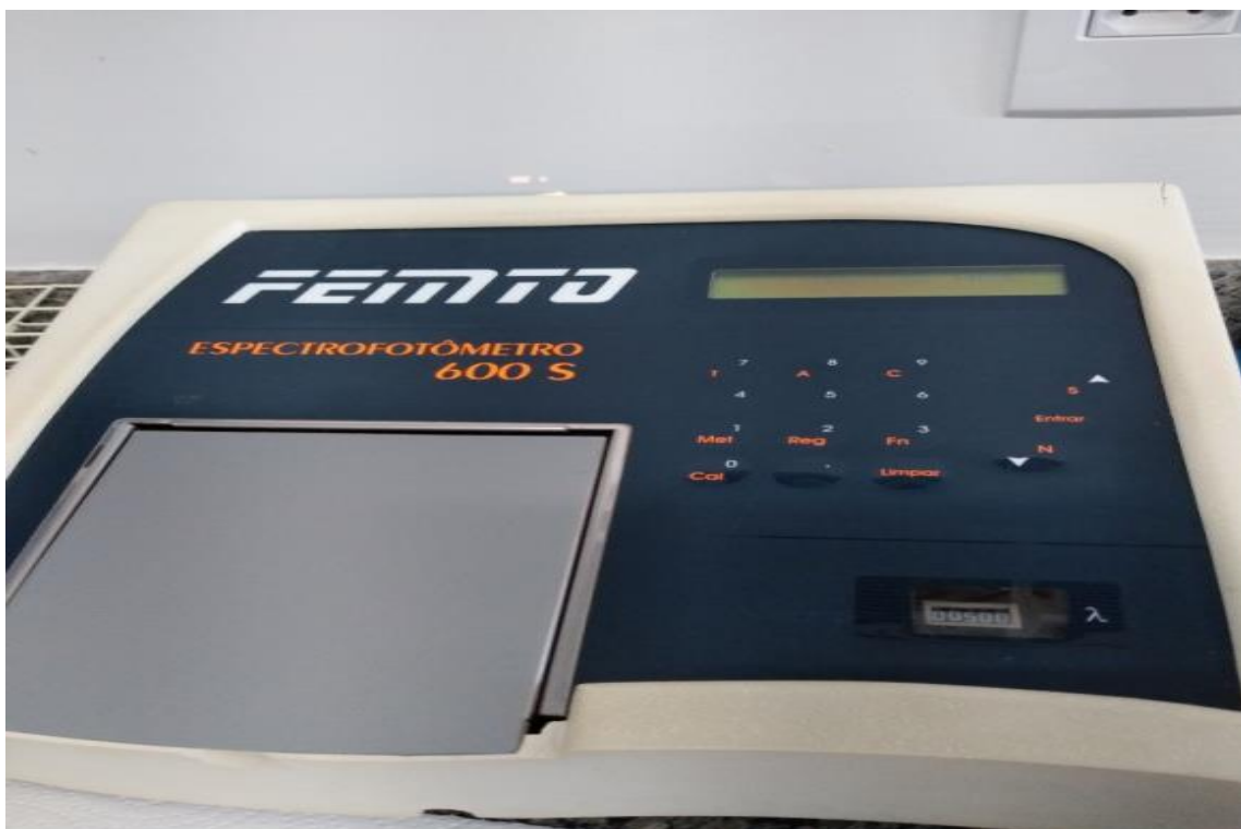
Figura 4- Determinou-se previamente a ocorrência de crescimento microbiano, sendo este confirmado pela leitura da densidade óptica (D.O) em espectrofotômetro para mensuração do grau de turvação.
