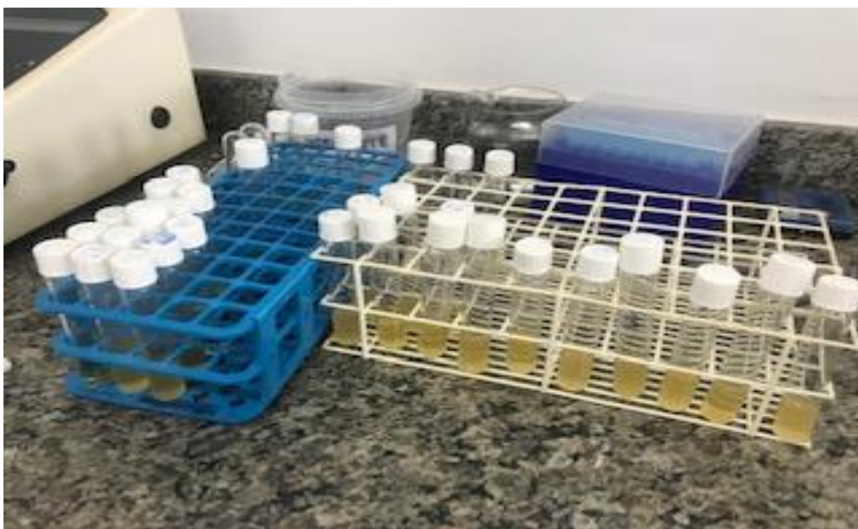
Figura 3 – Após 24 horas em estufa com temperatura 37°C. Realizou-se a verificação visual das culturas e por identificação da presença ou ausência de turvação do caldo.
